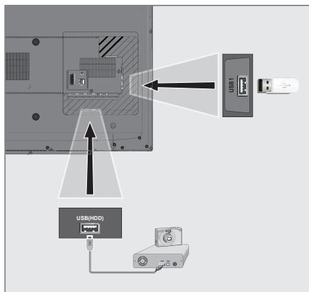
1 Buchse **USB(HDD)** des Fernsehgerätes und entsprechende Buchse des Datengerätes (externe Festplatte, Digital-Camera, Kartenlesegerät oder MP3-Player) mit einem USB-Kabel verbinden;
